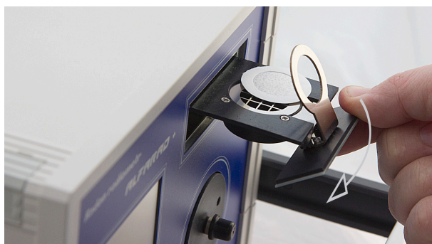
Рисунок 4д. Внешний вид БУ (Замена фильтра)
